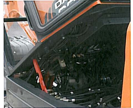
Cabina abatible para un fácil mantenimiento
