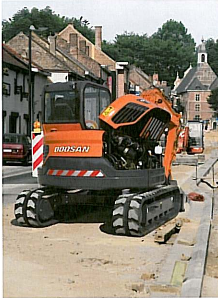
Fácil Mantenimiento: el acceso a las piezas del motor se realiza a través de los paneles laterales
